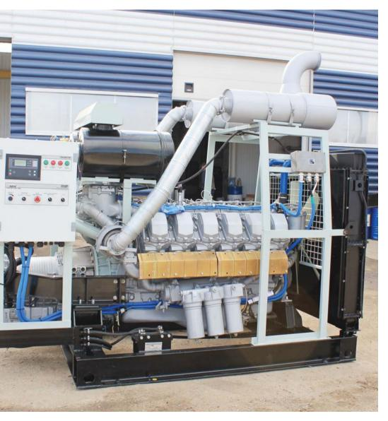
омплект дизельных приводов ЯСУ-500Б1М состоит из двух силовых агрегатов (ЯСУ-500Б1-01 и ЯСУ-500Б1-02) и предназначен для привода лебедки и ротора. Дизельные приводы ЯСУ-500Б1М поставляются в составе набора бурового оборудования, который используется для оснащения и мо-
