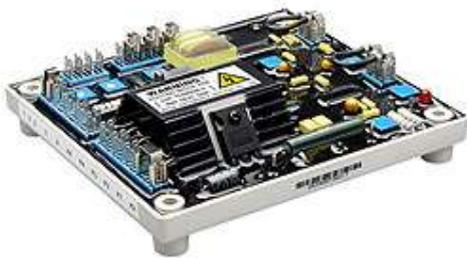
Регулятором напряжения EA341 (MX341) комплектуются генераторы предназначенные для параллельной работы.
