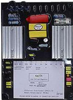
Генераторы ENGGA комплектуются автоматическими регуляторами напряжения WT-2. Данный регулятор может быть установлен взамен регулятора D-203 (устанавливался на старые модели генераторов ENGGA до 2007г.)
