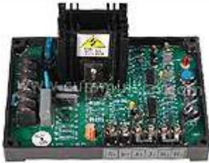
Регулятором напряжения CF-15A комплектуются синхронные генераторы производства TEMCO POWER INDUSTRY CO.
