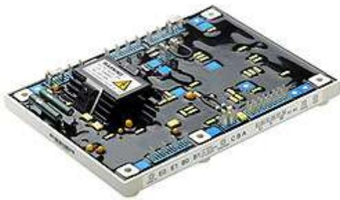
Регулятором напряжения EA321 (MX321) комплектуются генераторы предназначенные для параллельной работы.
