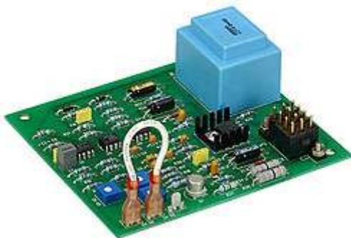
Регулятором напряжения EA3-KOH (C-255670) комплектуются генераторы производства KOHLER Power Systems.
