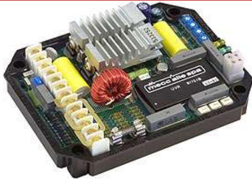
Регуляторами напряжения U.V.R.6/1-F AVR комплектуются генераторы серии ECO38, ECO40 и ECO43.
