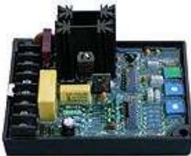
Регулятором напряжения CF-8A комплектуются синхронные генераторы производства TEMCO POWER INDUSTRY CO.
