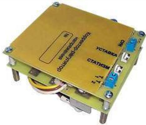
Корректор регулятор напряжения КРН-04 предназначен для систем возбуждения синхронных генераторов типа БГ. Обеспечивает устойчивую работу генераторов во всем диапазоне нагрузок с возможностью индивидуальной подстройки параметров регулирования.
