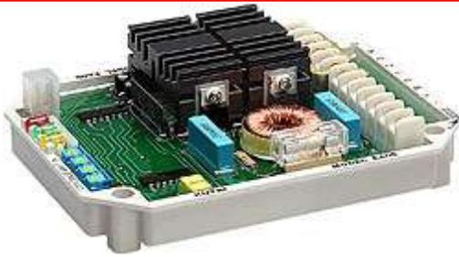
Регуляторами напряжения EA06 могут комплектоваться синхронные генераторы серии ECO38, ECO40 и ECO43.
