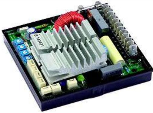
Регулятором напряжения S.R.7/2-G AVR комплектуются генераторы серии ECO32 и ECO34.
