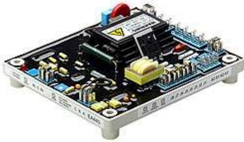
Регулятором напряжения EA440 (ZL440) комплектуются синхронные генераторы производства МЕ под торговой маркой ПСМ.
