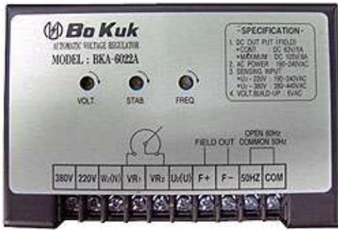
Генераторы VOKUK Electric IND комплектуются автоматическими регуляторами напряжения ВКА-6022А.
