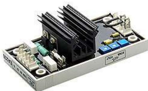
Регуляторами напряжения EA448 (R438 и R448) AVR комплектуются генераторы с системой возбуждения AREP, которая обеспечивает возможность работы при коротком замыкании с перегрузкой по току 3 I<sub>n</sub> в течение 10 с.
