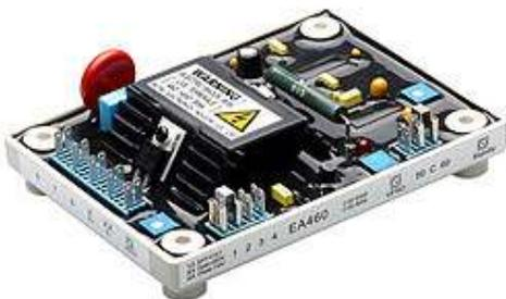
Предназначен для установки в качестве замены оригинальных AVR используемых при комплектации синхронных генераторов производства Cummins Generator Technologies.
