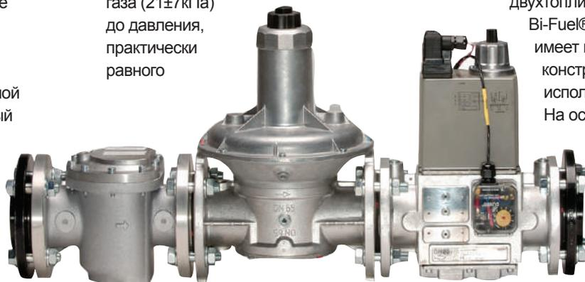
атмосферному. В конструкции реализована схема управления «по потребности», когда поток газа зависит от потока воздуха, поступающего в двигатель. С изменением нагрузки изменяется количество воздуха, поступающего в двигатель, что автоматически вызывает изменение потока газа, поступающего в газозвушный смеситель.
