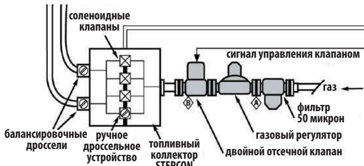
Опция STEPCON® позволяет эффективно использовать двухтопливную систему в более широком диапазоне нагрузок, дополняя базовую версию функцией оптимизации соотношения газ/дизель в ответ на быстрые изменения нагрузки.
