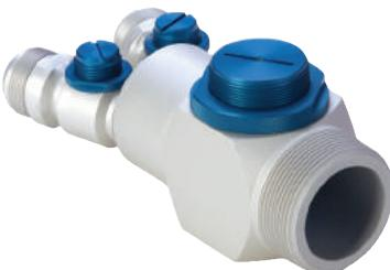
Дроссельное устройство совместно с газовоздушным смесителем и регулятором нулевого давления обеспечивает подачу в двигатель необходимого количества газа. Подобно газовоздушному смесителю, дроссель сконструирован в системе AUTO CAD, обработан на станке с ЧПУ и не нуждается в обслуживании.
