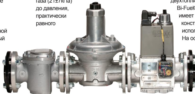
атмосферному. В конструкции реализована схема управления «по потребности», когда поток газа зависит от потока воздуха, поступающего в двигатель. С изменением нагрузки изменяется количество воздуха, поступающего в двигатель, что автоматически вызывает изменение потока газа, поступающего в газовоздушный смеситель.
