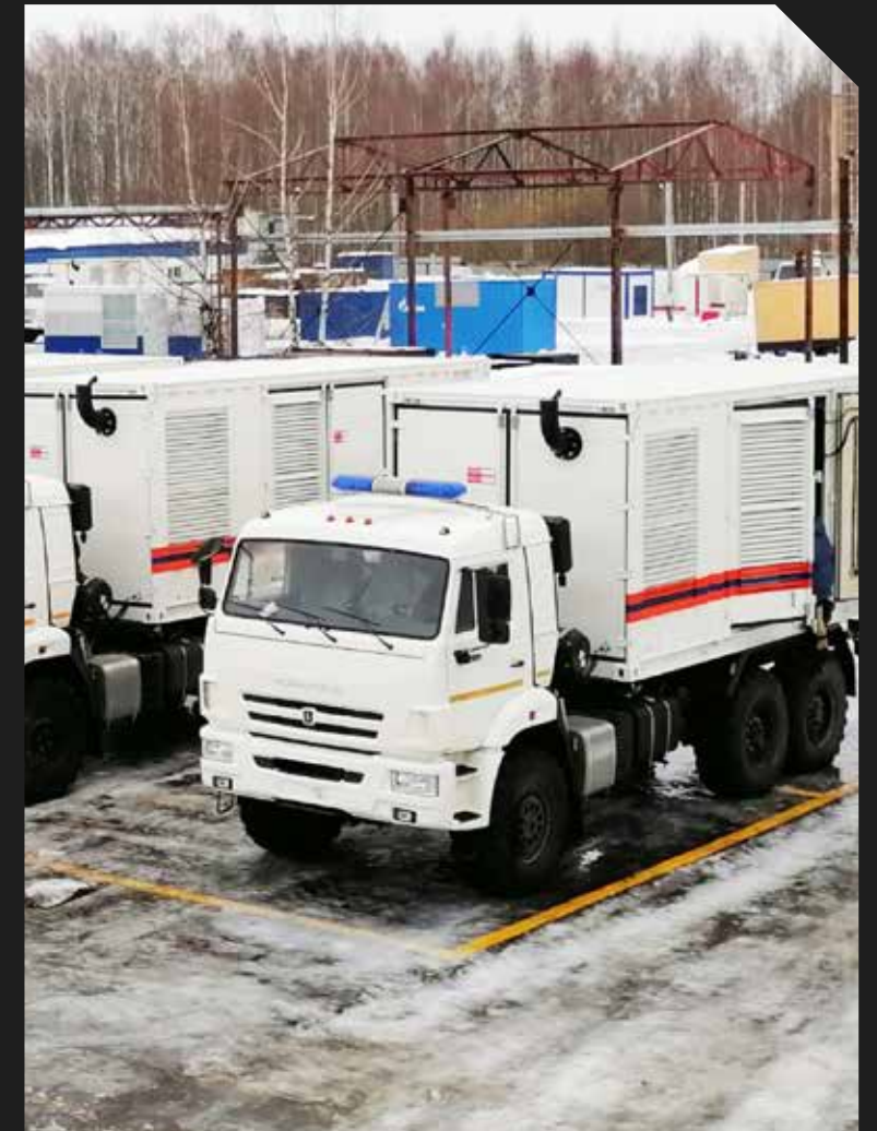
Rosseti 8.5 MW 便携式发电厂
