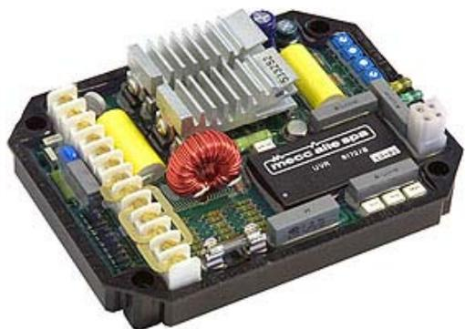
Регуляторами напряжения **U.V.R.6/1-F** AVR комплектуются генераторы серии ECO38, ECO40 и ECO43. остроен по аналогичной с S.R.7/2-G технологии с аналогичными характеристиками, но имеет дополнительные функции:
