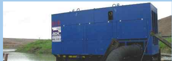
DNUV-1250/63, 2шт (двигатель TAD 1241VE) для перекачивания воды на Загорской гидроаккумулирующей электростанции
