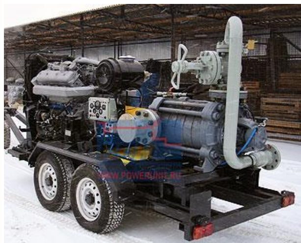
Передвижная насосная установка ДНУ 180/255
