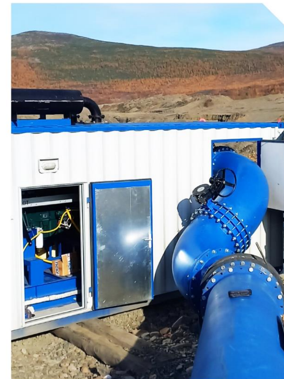
Дизельная насосная установка на базе Pioneer Pump для золотодобывающей компании
