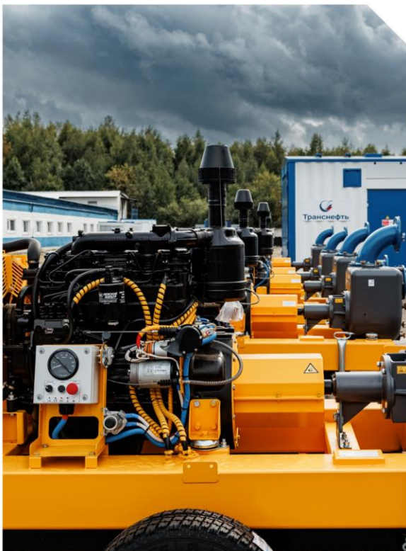
Дизельные насосные установки (ДНУ)
